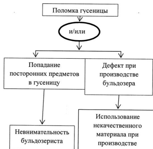
Рисунок 2 – «Дерево причин» при поломке ДТ и его гусеницы
