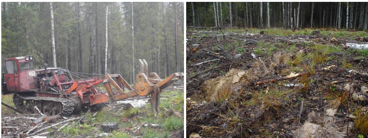
Рисунок 2 - Орудие роторное микроповышений на навеске трактора, подготовленные микроповышения на свежей вырубке. Фото Антонова Е.И.
